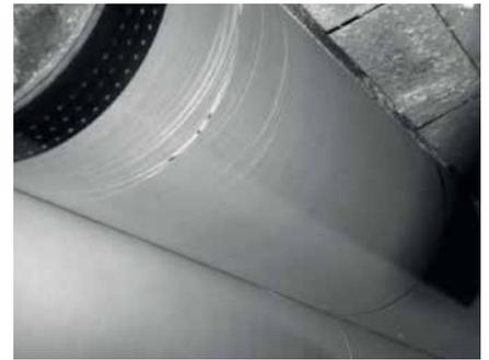
Las cámaras Procemex de Monitoreo de hoja, ubicadas estratégicamente a lo largo de la máquina de Tissue, proporcionan una visión adicional a los operadores y la información necesaria para determinar la causa raíz de un corte de hoja y se integra
